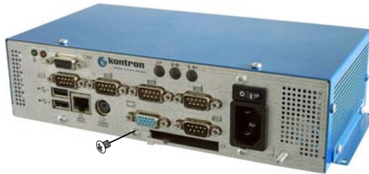
Abb. 9: Entfernen der Abdeckung des CompactFlash™-Steckplatzes-
