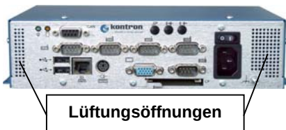
Abb. 14: Lüftungsöffnungen an der Frontseite
