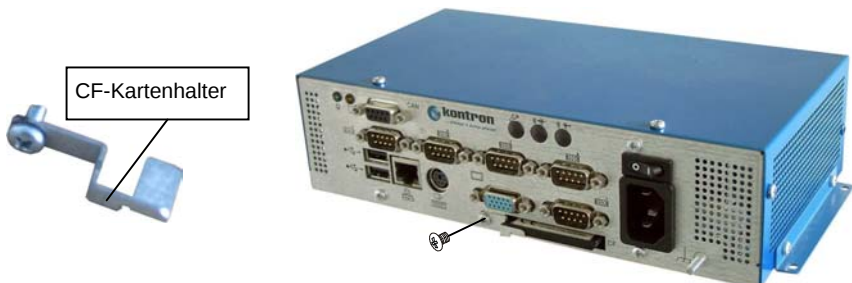
Abb. 11: Sichern der CF-Karte mit dem CF-Kartenhalter
