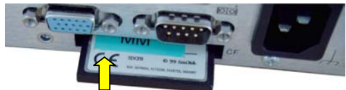
Abb. 10: Einfügen der CompactFlash™-Karte
