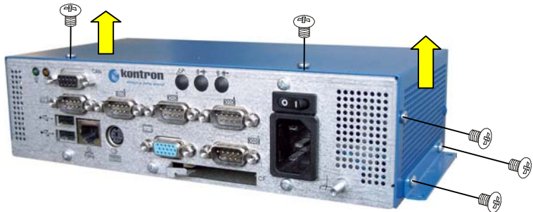
Abb. 20a: Entfernen der Kreuzschlitzschrauben an der oberen und rechten Geräteseite
