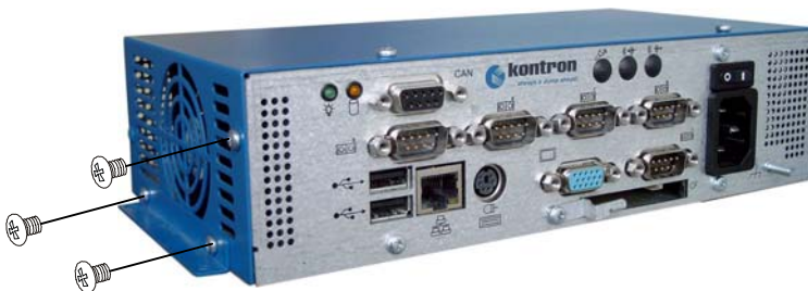
Abb. 20: Entfernen der Kreuzschlitzschrauben an der linken Geräteseite
