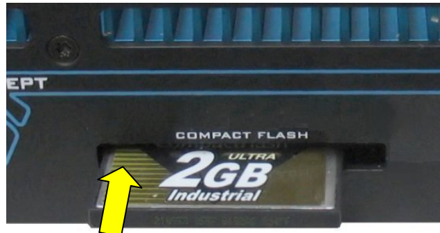
Abb. 15: Einsetzen der CompactFlash™-Karte
