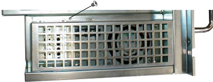
Abb. 11: untere Kabelschacht, dahinter liegt die AC Netzanschlussbuchse bzw. der Klemmblock für den DC-Anschluss
